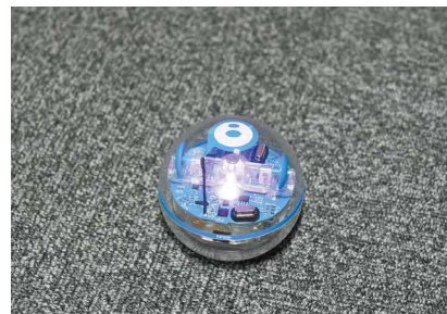
▲今回の講座で使用したボール型ロボットSpark+。プログラムに合わせて、さまざまな方向に動いたり、いろいろな色に光ったりします。
