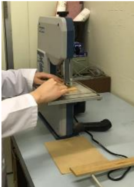
図1 学生がはじめてバンドソーを使用し、廃棄物(木粉)を取得している様子
